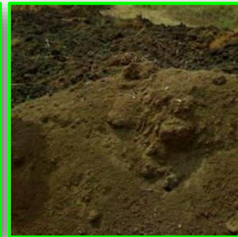
Иловый осадок сточных вод влажностью 40-50%
