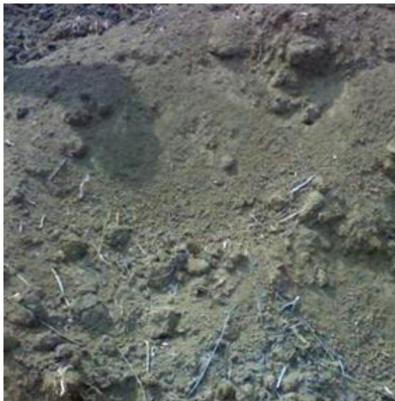
Рис. 3. Иловый осадок сточных вод влажностью 55-60%, обезвоженный на иловых картах
